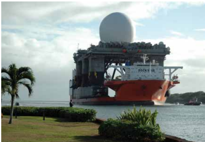
Мобильная морская РЛС X-Band, используемая в решении задач оповещения о запусках в интересах ПРО США
